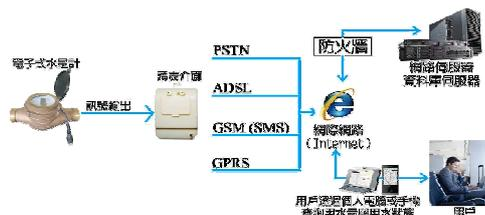
圖 1 即時監測管理系統基本架構示意圖
