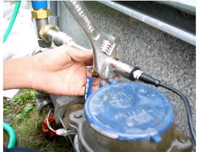
圖 5 接上壓力傳感器
