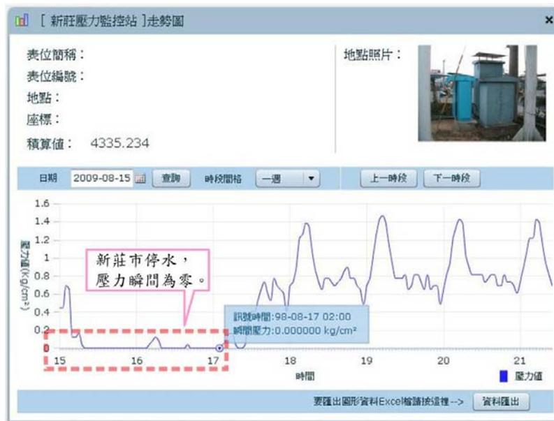
圖 15 因管線施工，十五日至十七日停水，後續壓力呈現週期性狀態
