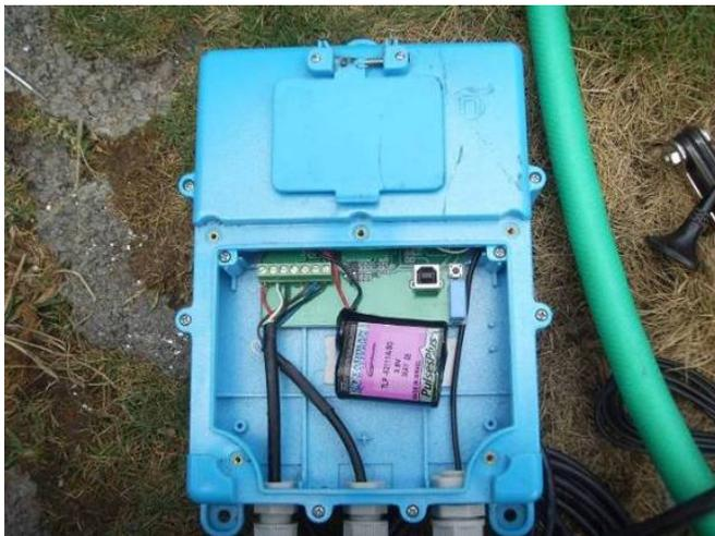
圖 6 傳訊介面連結壓力計與水量計
